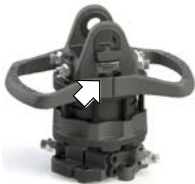
Рисунок 1.14 — Расположение маркировочной таблички ротатора
